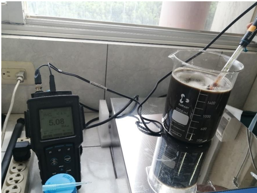
Cálculo del pH, empleando pH-metro.
