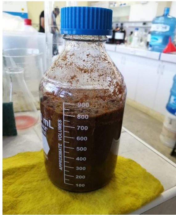
Hidrolizado después de salir de la autoclave.
