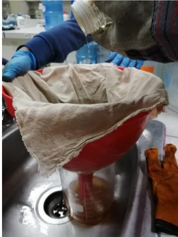
Filtrado del hidrolizado de bagacillo de caña de azúcar, con tela de nailon.
