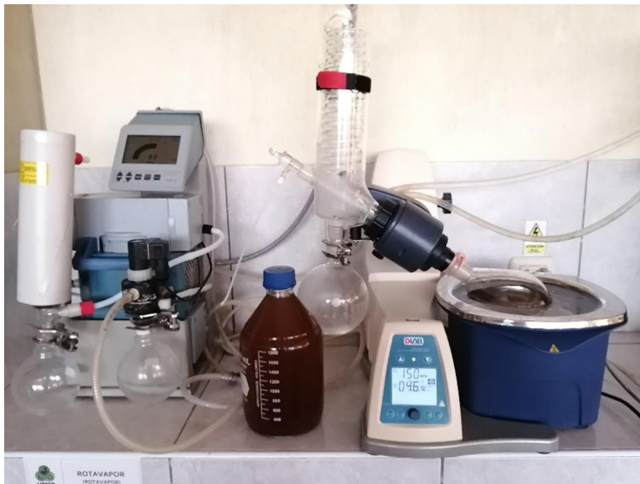
Concentración del hidrolizado usando rotavapor.
