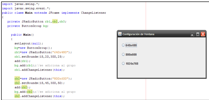
IMAGEN N° 03-0040: Formulario con tres controles Radio Button en ejecución
